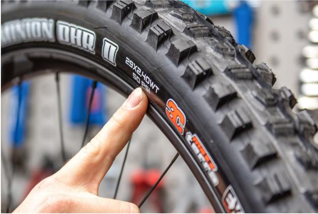
Reifen nicht von den passenden Felgen abgestützt, «walkt» er in den Kurven.
